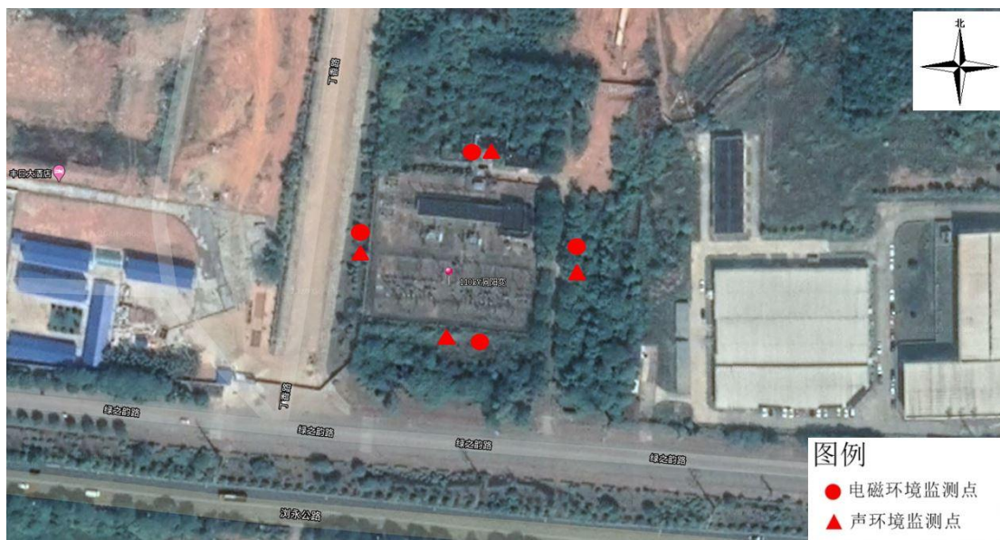
图 1 洞阳 110kV 变电站监测布点示意图
