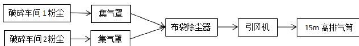
图 1-5 破碎车间粉尘治理工艺
