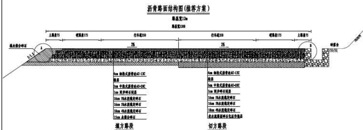
图 1.5-2 沥青混凝土路面结构图
